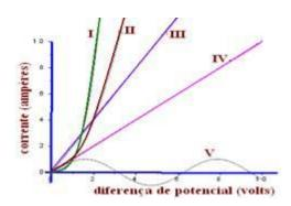
Todos os condutores, de tipo cilíndrico, foram produzidos com os mesmos comprimentos e raios.
