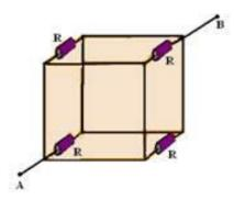
Aplicando entre os pontos A e B uma diferença de potencial U, a corrente que circulará entre A e B valerá:
