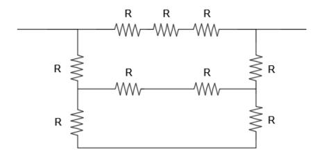
A resistência equivalente entre os terminais X e Y, em ohms, é igual a:
