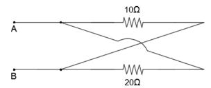
A resistência equivalente R, entre os pontos P e Q, em ohms, da combinação de resistores mostrada na figura é:
